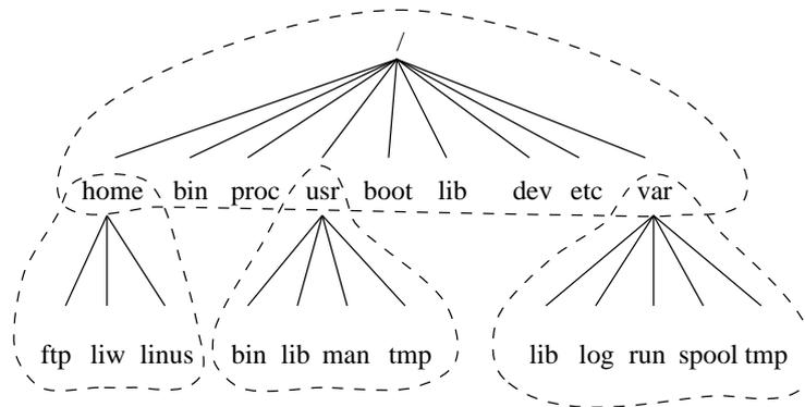
Figura 3.1: Parti di un albero delle directory Unix. Le linee tratteggiate indicano i limiti delle partizioni.
