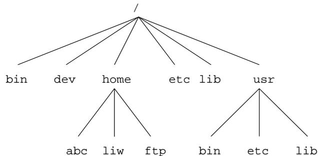
Figura 4.4: Sono stati montati **/home** e **/usr**.
