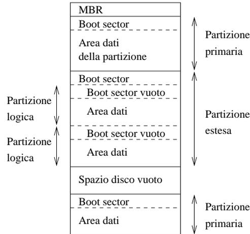
Figura 4.2: Un esempio di partizionamento di hard disk.
